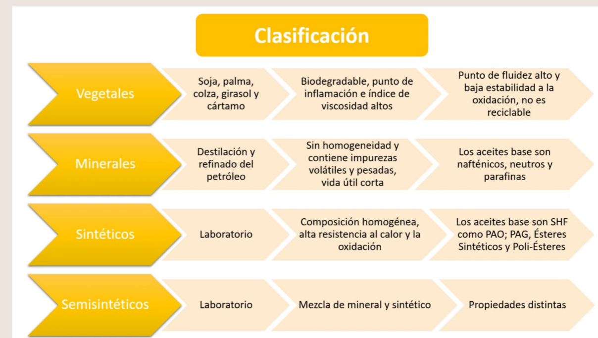
Cuadro 2.6. Clasificación de los aceites para motores de combustión interna según su origen de elaboración.
